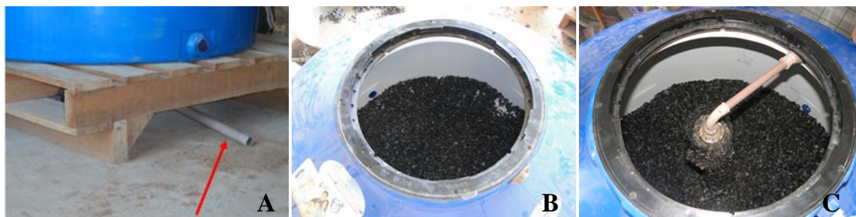
Figura 2: Preparação dos biorreatores (A) Coletor de chorume (B) Camada de brita para drenagem do chorume (C) Dreno de biogás.
