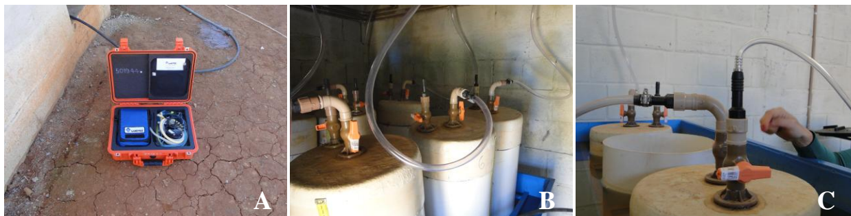
Figura 3: Monitoramento do volume, pressão e composição do biogás produzido nos biorreatores. (A) Analisador de gás GEM 5000 Landtec® (B) Gasômetros (C) Medição da pressão do gasômetro
